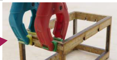
15 : Chaque section est collée et maintenue par des pinces.
