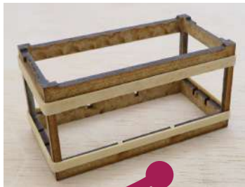
13 : Les quatre faces sont assemblées et maintenues par des élastiques.
