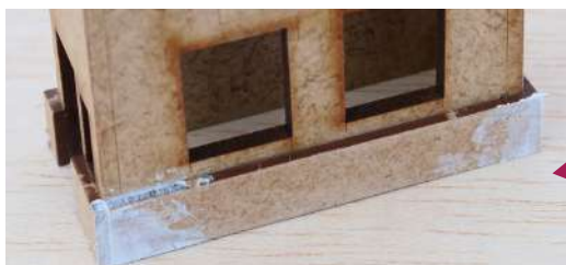
5 : Les joints masqués à l'enduit de finition, poncé après séchage.
