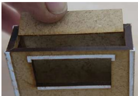
37 : Une plaque de 1.0mm permet de centrer la cabine sur la partie basse du bâtiment. Vérifiez qu'elle rentre bien.
