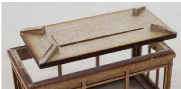
45 : Les pointes des consoles sont reprises à la lime pour épouser les angles du socle.
