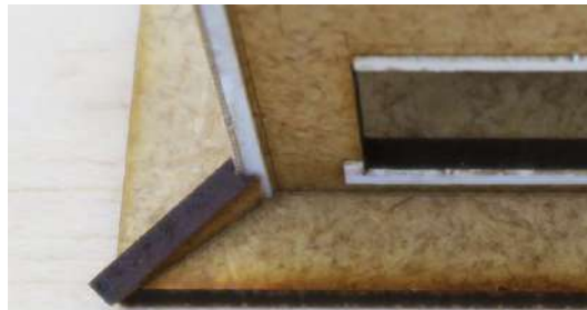
43 : Les consoles sont ajustées et collées dans les angles (voir repères gravés).
