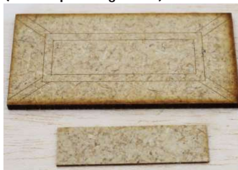
38 : Cette plaque est collée au centre du socle de la cabine (voir repères gravés).
